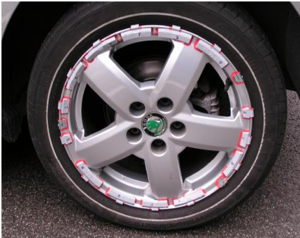
Foto 6 Uspořádání vyvažovacích závaží RE 10,15,40,45,50,55,60, na litém kole
