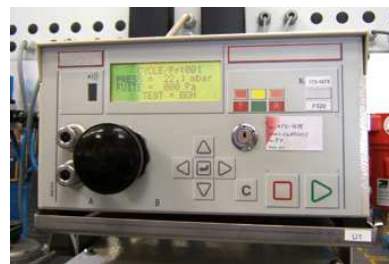
100% autom. kontrola uniku vzduchu ventilů
