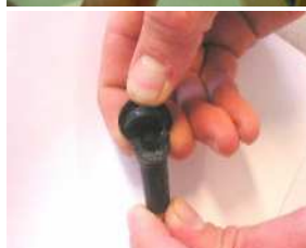
Odtržený ventil
